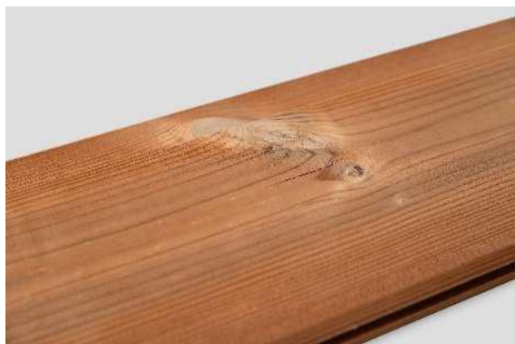
Dopuszczalne są drobne uszkodzenia/ rozszczepienia powierzchni.
