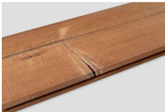
Dopuszczalne są pojedyncze pęknięcia sęków.
