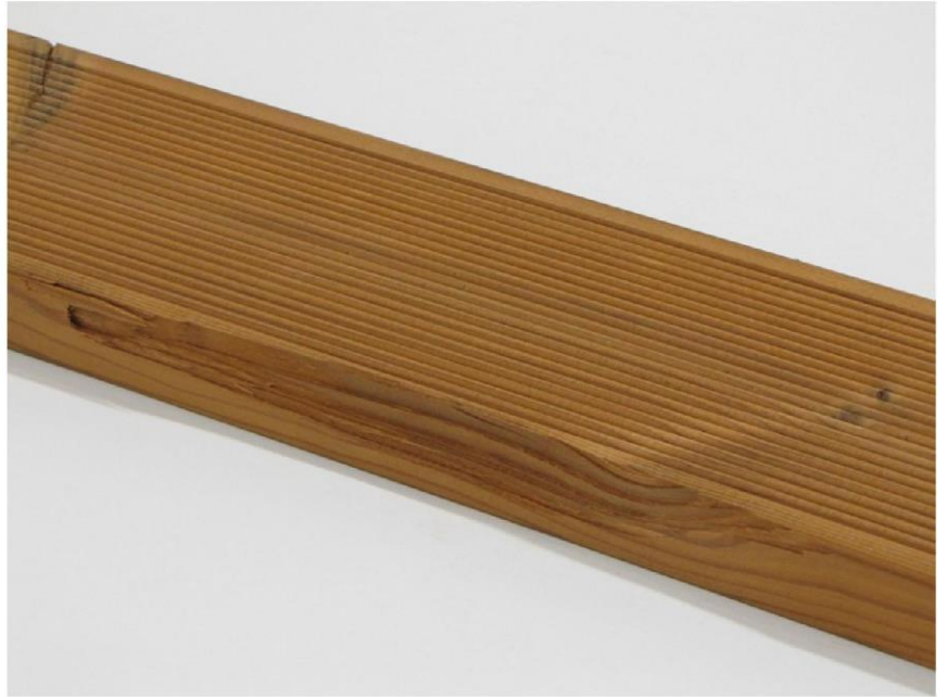
Dopuszczalne są częściowo wadliwe krawędzie.
