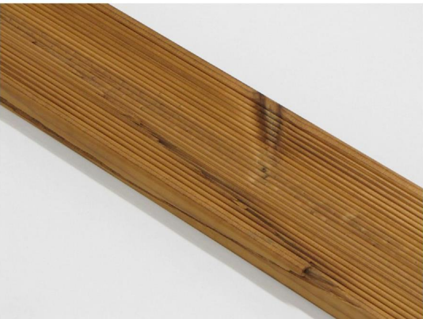
Dopuszczalne są znaczne pęknięcia na krawędziach.
