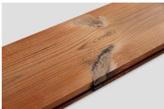
Dopuszczalne są pojedyncze czarne częściowo zrośnięte sęki.
