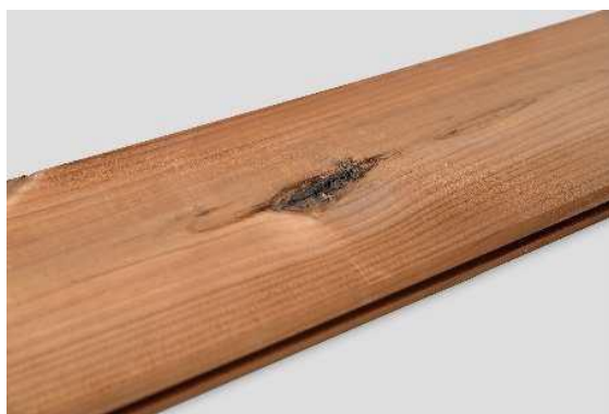
Dopuszczalne są pojedyncze braki w sękach.
