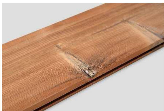
Dopuszczalne są nieznaczne braki w sękach (również czarnych) na krawędzi.
